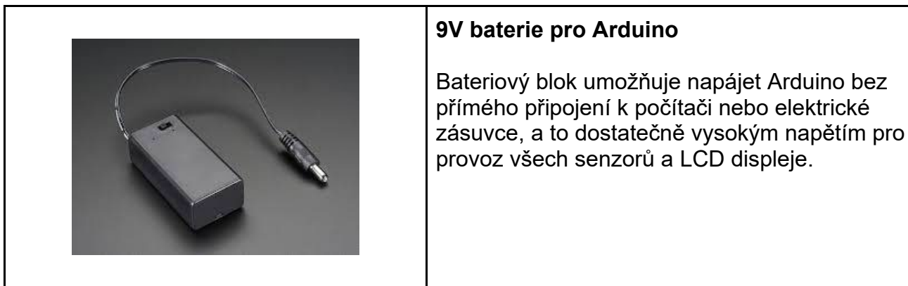
Obrázek 1.1 - Elektronické komponenty potřebné k výrobě řídicí jednotky kvality vzduchu STAIR.
